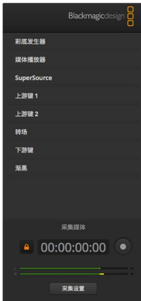
Capture (采集) 设置面板位于各处理设置面板的最下方
