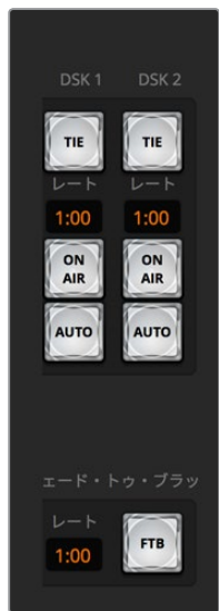
ダウンストリームキーヤー とフェード・トゥ・ブラック
