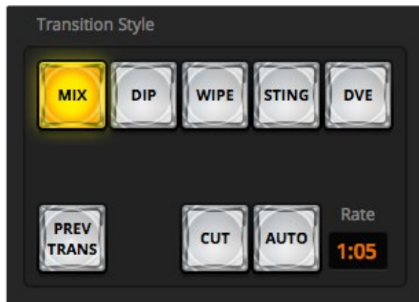
Кнопка Cut в блоке Transition Style
