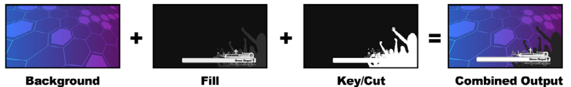
Kombinieren eines Füllungs- und Stanzsignals in Form eines Linear-Keys
