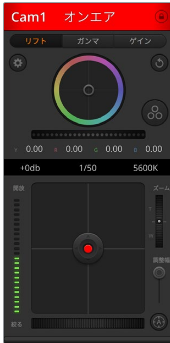
ATEM Camera Controlを使用して、Blackmagic Studio CameraをATEMスイッチャーからコントロール
