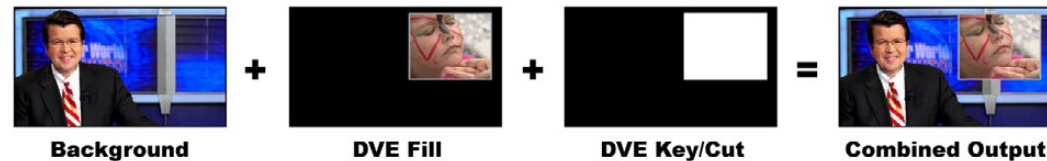
Combinación de la imagen de fondo, la imagen superpuesta y la máscara para DVE
