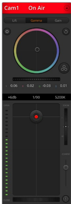
ATEM Camera Control позволяет управлять камерами Blackmagic Studio Camera с видеомикшера ATEM
