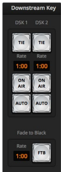
Incrustation en aval et fondu au noir
