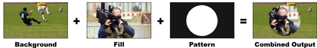
Ein Hintergrundbild wird mit einem Füllungs- und Muster-Key kombiniert
