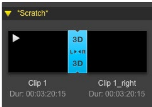
Cuando se muestran las imágenes en miniatura, las secuencias correspondientes a cada ojo aparecen unidas mediante un ícono ubicado entre ambas.
