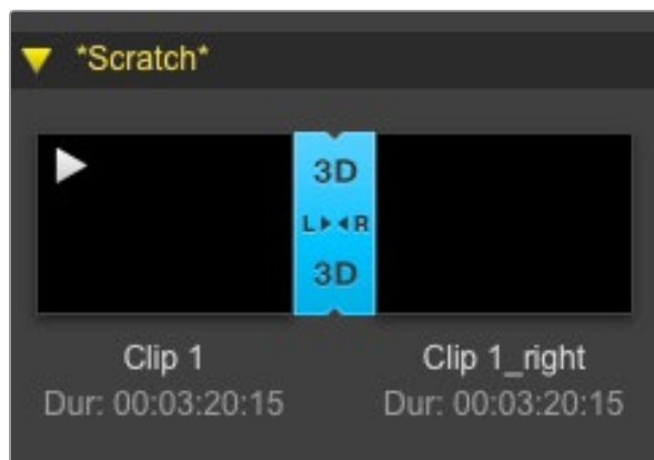
Клипы для левого и правого каналов объединяются с помощью 3D-индикатора в списке Thumbnail и изображены в виде одного большого значка.
